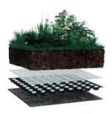
L'épaisseur totale du complexe depuis le géotextile de protection jusqu'au substrat est comprise entre 16 et 28 cm environ selon l'élément de drainage utilisé. La pente est comprise entre 0 et 9 %.
