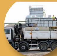
☑ La mise en oeuvre de la couverture alternative EuroCover LF est réalisée au moyen d'un hydropropulseur de grande capacité de 10 à 17000 litres.
